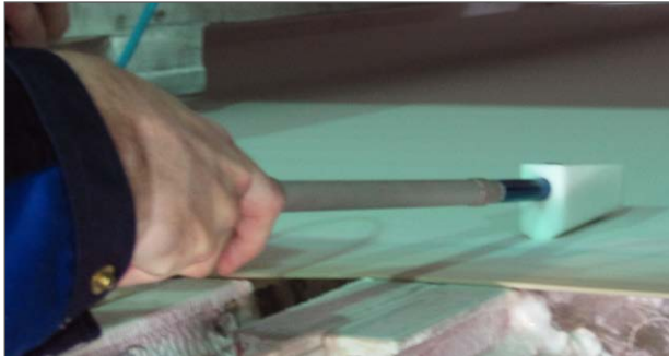
Figura 4 - medición de flujo de aire en la caja Uhle
